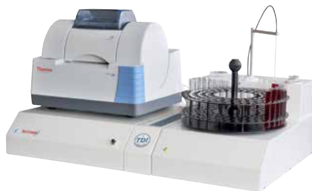
Figura 5. Bacchus 3, el analizador multiparamétrico FTIR comercializado por TDI, permite obtener los parámetros enológicos más importantes sin consumo de reactivos químicos.
