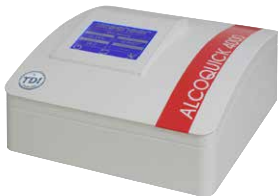
Figura 4. Alcoquick 4000, el analizador NIR ideal para la determinación rápida y precisa del grado alcohólico.
